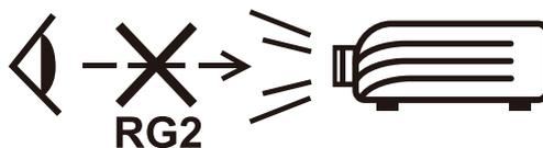
**ВНИМАНИЕ!** Данное изделие может являться источником потенциально опасного оптического излучения. Как и в случае с любым другим источником яркого света не смотрите в луч света, RG2 IEC 62471-5:2015. Дополнительное предупреждение о воздействии на глаза с расстояния менее 1 м.
